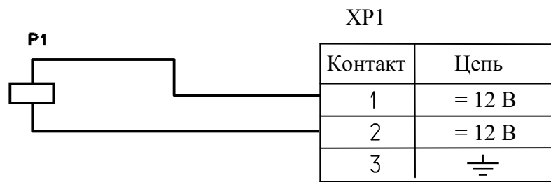
Рис. 2 Принципиальная электрическая схема клапанов ЭМКГ8-25-10-12-нж472Е, ЭМКГ8-25-10-12-нж472Е-01. P1 – катушка; XR1 – разъем.
